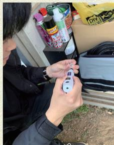
③次に、リユーターを使って表面を滑らかにしていきます。耳に装着する部分なので少しでもざらつきがあれば、解消します。
