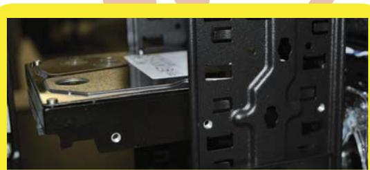
ハードディスクと光学ドライブをケース内部前面に挿し込み、固定します。
