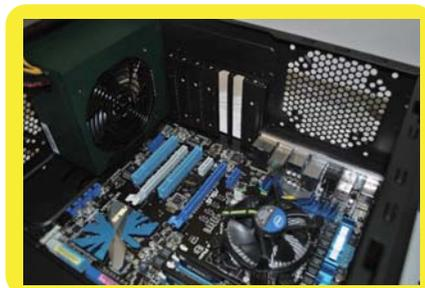
スペーサーとマザーボードの穴の位置を合わせ、ネジで固定します。
