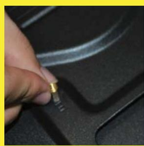
ケースとマザーボードが直接接触するのを防ぐため、スペーサーを取り付けます。ここで、IOパネルも取り付けておきます。
