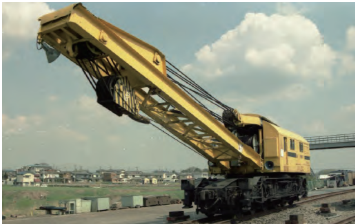
東大宮操車場の名物だった 65t 操重車ソ 80 形 バックは宇都宮線 (1988 年撮影)
