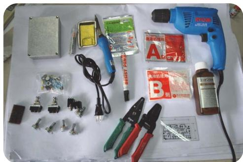
今回は写真の道具をつかって制作していきます。機材としてはんだ付けの道具、ハンドドリル、エッチング機材などが必要で、部品はボリューム、フットスイッチ、ジャック、抵抗やダイオードなどの素子、アルミダイキャストケースなどを使っています。
