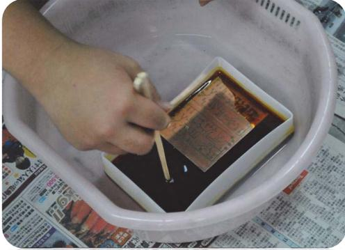
先ほどと似たような作業ですが、今度はエッチング液に漬けていきます。エッチング液の反応しやすい温度で作業するために、湯煎で温度を40度くらいにしジャブジャブやっていきます。
