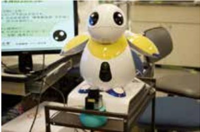
▶松日案研究室の学生さんが使用しているインターフェースロボット。人の位置や移動に反応し挨拶するようプログラムされている。
