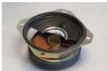
図2 ユニットの断面
